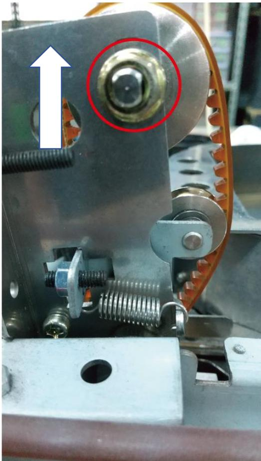
ピックアップの先端部分を上に持ち上げて、丸印のボルトをスパナで緩めて、矢印の方向に少し移動します。
